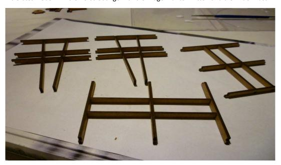
Die Teile für die Mitte werden dann mit den Seitenwagen verbunden. In zwei Seitenwangen sind kleine Löcher für die Handbremse vorgesehen. Diese gehören zu einer Wagenhälfte.
